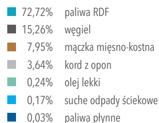
STRUKTURA CIEPŁA Z POSZCZEGÓLNYCH PALIW DO PRODUKCJI KLINKIERU W 2015 ROKU W CEMENTOWNI CHEŁM
