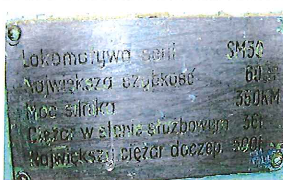
Fot. 6 - Tabliczka typu w kabinie
